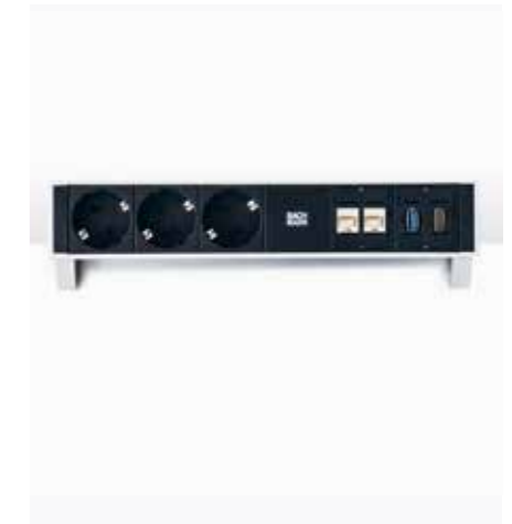
Elektrifizierungsmodul, an der Tischplatte montierbar 3 x Schutzkontaktstecker, 2 x Ethernet (CAT6 RJ45), 1 x USB 3.0, 1 x HDMI
